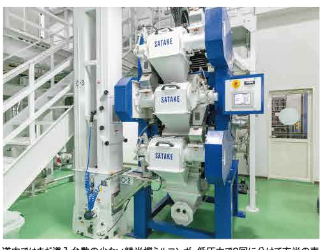
道内ではまだ導入台数の少ない精米機ミルコンボ。低圧力で3回に分けて玄米の表面を削るため、米本来のうま味と食感が楽しめます
